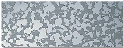
Hloubka leptaných míst se řídí podle délky času, kdy je nerezová ocel vystavena působení kyseliny.
